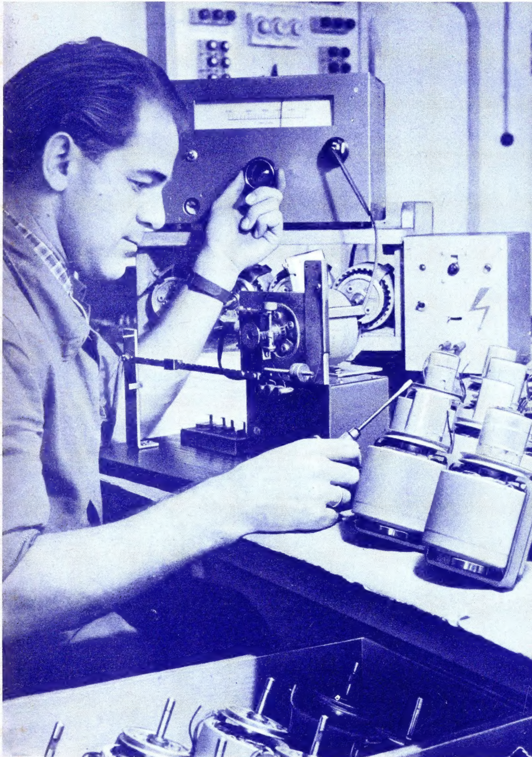
Prüfung der Laufeigenschaften von Motoren für Drahttongeräte. Die Drehzahl wird bei verschiedenen Belastungen stroboskopisch mit der Frequenz eines Tongenerators verglichen. Bei Belastungsschwankungen bis zu 40% darf sich die Drehzahl um höchstens 1% ändern.
